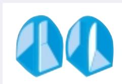
*Ottimo il passaggio dell'aria fra le celle tramite canali di aerazione. Ogni cella si muove indipendentemente (6 gradi di libertà di movimento), prevenendo frizioni e forze di taglio.*
